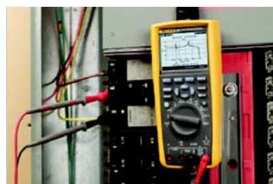
Fluke 289 真有效值 (True-rms) 工业记录万用表, 具趋势捕获功能
